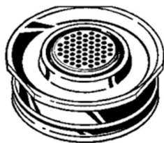
Κάψουλα δοσολογίας τοποθετημένη μέσα στον θάλαμο πλήρωσης
