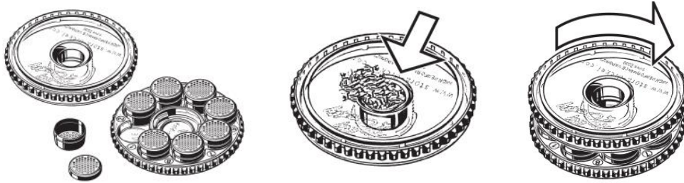
ΚΑΨΟΥΛΑ ΔΟΣΟΛΟΓΙΑΣ ΚΑΤΑ ΤΟ ΓΕΜΙΣΜΑ ΜΕ ΤΟ ΚΑΠΑΚΙ ΤΟΥ ΓΕΜΙΣΤΗΡΑ (ΧΟΑΝΗ) ΚΑΙ ΤΟΠΟΘΕΤΗΣΗ ΤΟΥ ΚΑΠΑΚΙΟΥ ΣΤΟ ΓΕΜΙΣΤΗΡΑ
