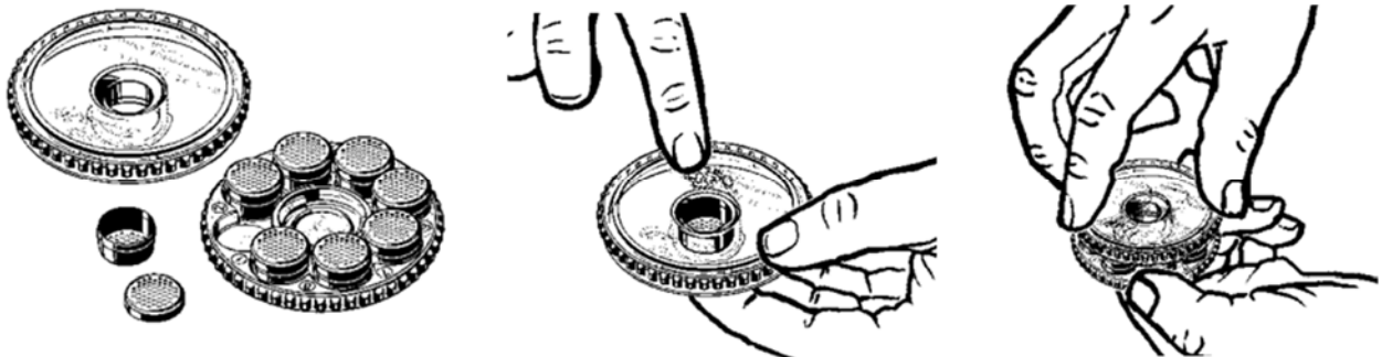
Κάψουλα δοσολογίας κατά το γέμισμα με το καπάκι του γεμιστήρα (χοάνη) και τοποθέτηση του καπακιού του γεμιστήρα
